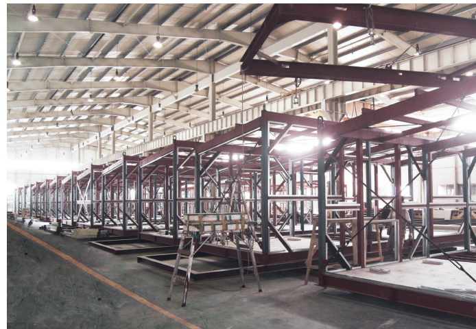
단위모듈의 크기와 형태는 모듈의 운송조건, 건물의 평면구성등에 의해 결정됩니다. / W: 2.4~4.5m / L: 6~16m / H: 2.7~4.2m
